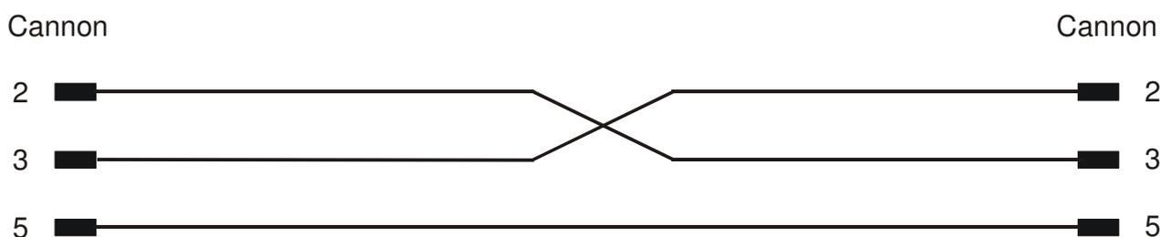
Zapojení konektoru Cannon 9 pin:
